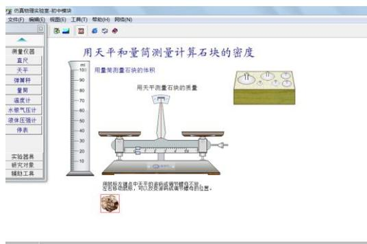
学生可以充分利用虚拟仿真实验来探究如果把物体和砝码放反了会怎么样？游码右移的作用到底是什么？同样，在测量物体的密度演示实验中，对量筒读数时要与凹液面最低处相切，教师在操作过程中凹液面并不是十分明显，学生对这个概念不是很理解；
